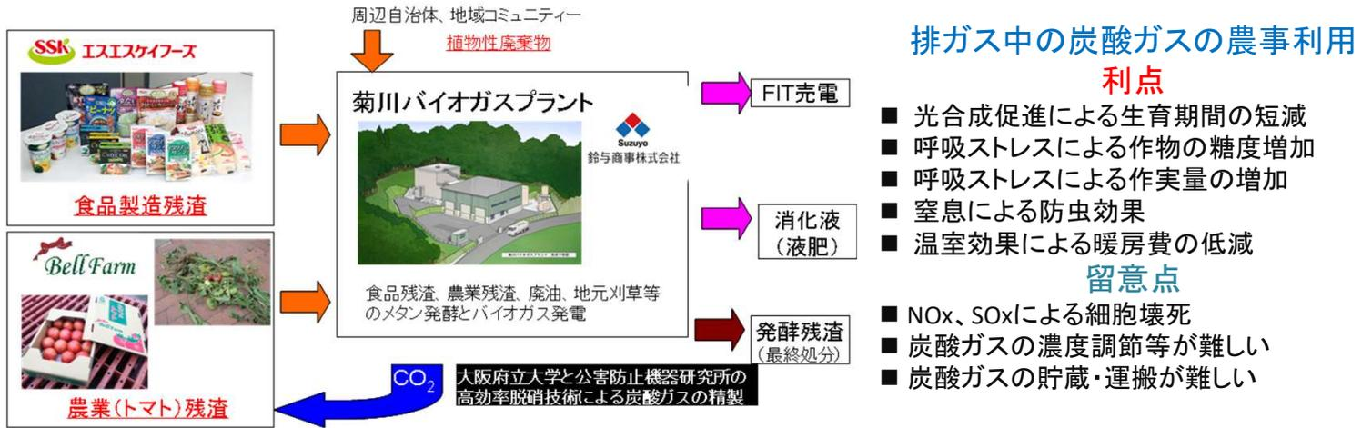
メタンガス発電の排ガスには窒素酸化物(600-2000ppm)が含まれており、植物の葉などを壊死させるためそのままでは農事利用できない。そこで、ガラス繊維式ガス吸収装置(公害防止機器研究所製)を用いて鈴与商事と排ガス中の窒素酸化物を10ppm以下に落とし、農事利用する実証プラントを建設した。
