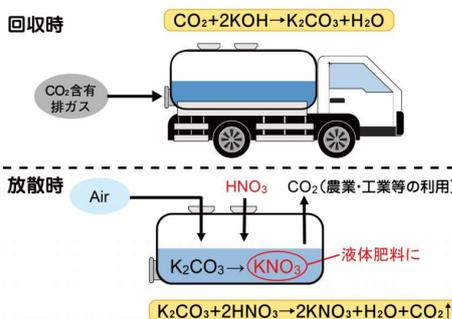
NO触媒酸化、NOオゾン酸化およびNOx水吸収プロセスを組合せ、NOxを98%以上(10ppm以下)にする技術をもとに、メタンガス発電システム排ガスの炭酸ガスの農事利用を検討し、一定の成果を得た。今後、炭酸ガスの貯留・輸送方法の確立が課題となる。
